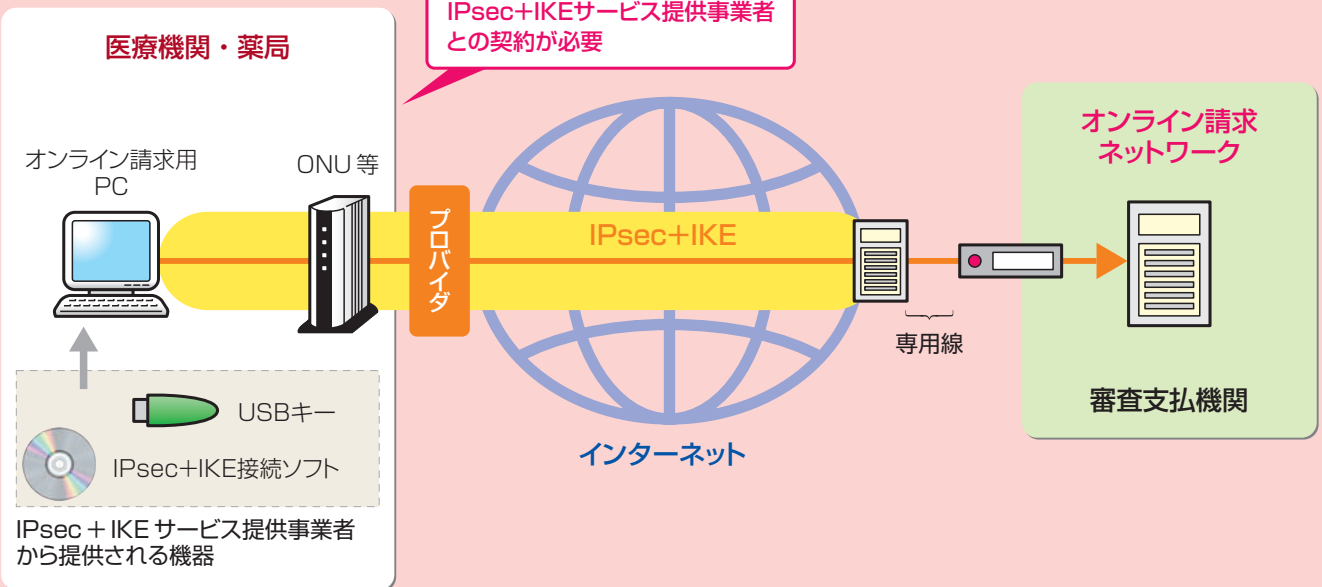
インターネット (IPsec+IKE) 接続の構成 (例2)
